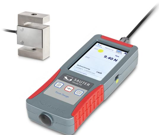
Abmessungen Messzelle 50,8×76,2×25,4 mm
